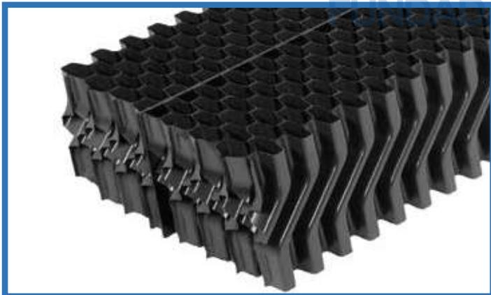
Se localiza entre el ventilador y el sistema de aspersión de agua, fabricado en PVC de forma laberíntica (opciones en aluminio y acero inoxidable), ensamblado en paneles fáciles de montar.
