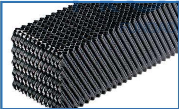
Fabricado en PVC ó CPVC, autoextinguible y de alta resistencia al ataque químico, características que permiten tenerlo en contacto con aguas limpias, duras o contaminadas, su diseño de láminas termoformadas corrugadas, permiten un contacto íntimo entre los flujos de agua y aire, lográndose una gran transferencia de calor. Está ensamblado en módulos fáciles de instalar y desinstalar para limpieza. Disponible en separaciones de 12 mm y 19 mm entre láminas.
